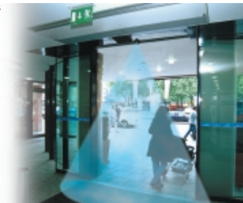
Lobes de détection en fonction de la position latérale de l'antenne hauteur de montage : 2,2 m sensibilité : 6
